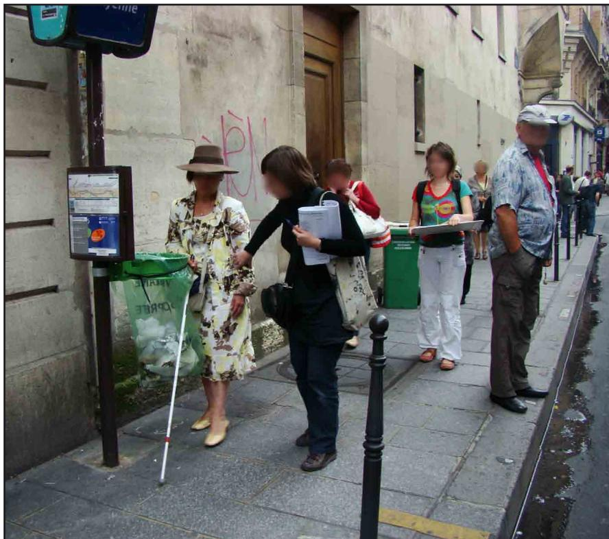
Une corbeille, fixée sur le poteau de l'arrêt bus, se trouve en travers le cheminement. Cette configuration constitue un réel obstacle pour les personnes ayant un handicap visuel.
